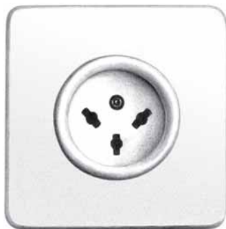
Novější varianta zásuvky typu H s otvory pro obě varianty zástrček. Zemnění je dole uprostřed, fázový vodič je vpravo.
